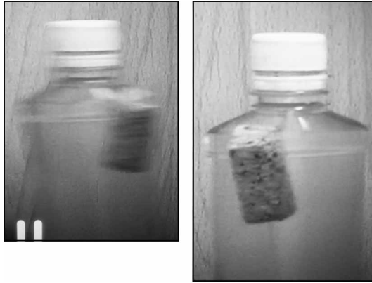
Рис. 2. Отклонение поплавка: a – при разгоне, b – при торможении
