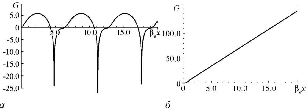
Рис. 7. Зависимость коэффициента усиления от безразмерной длины пространства взаимодействия при  $Y = 0.982$  (а);  $Y = 1.0535 - 0.015j$  (б).  $\beta_e d = 2\beta_e y_0 = 2.0, \Omega_{\text{пл}}^2/\omega_c = 0.1, \xi = \psi = 10^{-3}$
