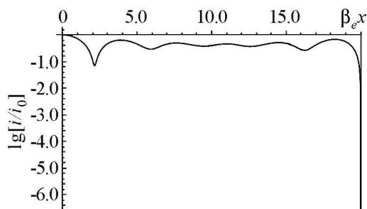
Рис. 8. Зависимость  $\lg[i/i_0]$  от безразмерной длины пространства взаимодействия в случае подавления при  $\beta_e d = 2\beta_e y_0 = 2.0$ ,  $\Omega_{пл}^2/(\omega_c \omega) = 0.1$ ,  $Y = 1.07 - 0.005j$ ,  $\beta_e l = 20$
