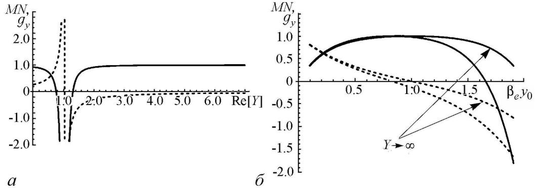
Рис. 6. Зависимость  $MN$  (сплошные линии) и  $g_y$  (пунктир) от  $\text{Re}[Y]$  при  $\beta_e d = 2\beta_e y_0 = 2.0$  (а) и от  $\beta_e y_0$  при  $\beta_e d = 2.0, \text{Re}[Y] = 3.0$  (б)
