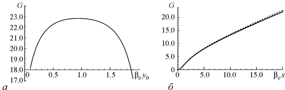
Рис. 4. Зависимость коэффициента усиления от положения пучка при  $\beta_e x = 20.0$ ,  $\operatorname{Re}[Y] = 101$  (а) и от безразмерной длины пространства взаимодействия при  $\beta_e y_0 = 1.0$  (б).  $\beta_e d = 2.0$ ,  $\Omega_{\text{пл}}^2 / \omega_0 = 0.1$ ,  $\xi = \psi = 10^{-3}$ ,  $\operatorname{Re}[Y] = 0.1$  – сплошная линия и  $Y \rightarrow \infty$  – пунктир
