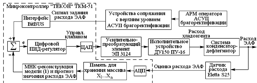
Рис. 8. Функциональная схема системы автоматического управления расходом ЭАФ в АСУП брагоректификации с прогнозом нелинейных колебаний в системе дефлегматор – конденсатор
