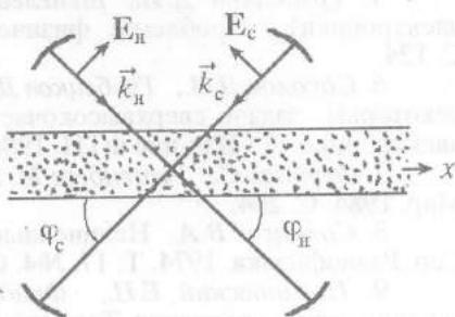
Рис. Схема модели ЛСЭ, в которой на электронный поток действует поле двух электромагнитных волн  $\mathbf{E} = \text{Re}[E_n \exp[i(\omega_n t - k_n r)] + E_c \exp[i(\omega_c t - k_c r)]]$ , индексы « $n$ » и « $c$ » относятся к полю накачки и сигнала соответственно
