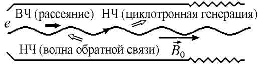
Рис. 1. Схема двухчастотного генератора, в котором попутная (по отношению к поступательному движению электронов) низкочастотная волна возбуждается винтовым электронным пучком в условиях циклотронного резонанса; встречная низкочастотная волна обратной связи рассеивается на пучке в волну на более высокой частоте
