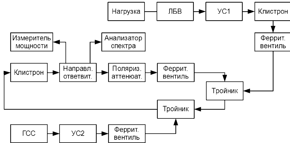
Рис. 1. Измерительный комплекс для исследования влияния внешнего сигнала на колебания клистронного генератора в присутствии шума
