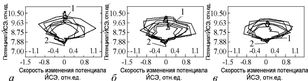
Рис. 3. Фазовые портреты при разной концентрации микропримесей ацетона: а – 1.70%, б – 3.20%, в – 4.80%. Здесь и далее ЙСЭ – йодо-селективный электрод; 1 – точка начала осцилляций, 2 – точка окончания осцилляций
