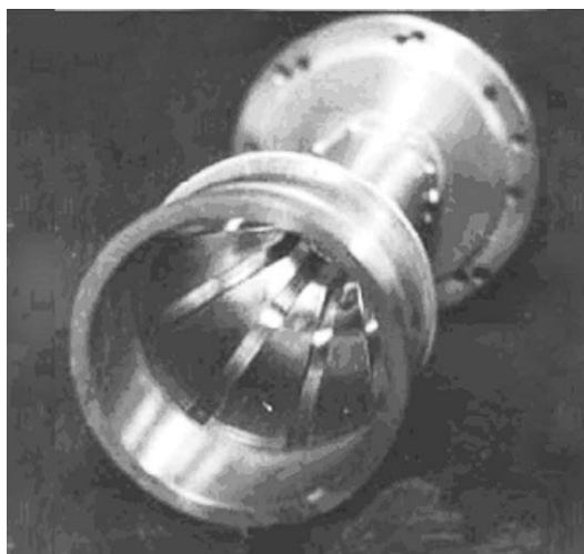
Рис. 2. Первый релятивистский магнетрон с аксиальным выводом излучения через коническую антенну, содержащую резонаторы с уменьшающейся глубиной [2]
