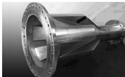
Рис. 6. Экспериментальный магнетрон с оптимизированным выводом излучения [9]
