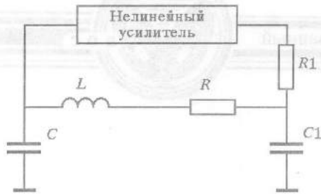
Рис. 1. Функциональная блок-схема генератора, используемого в работе
